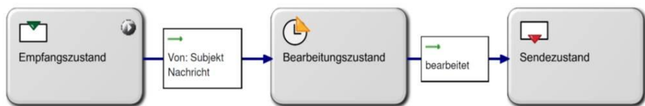
Abb. 4: Modellierung aus subjektinterner Sicht: Empfangen, Bearbeiten, Senden
